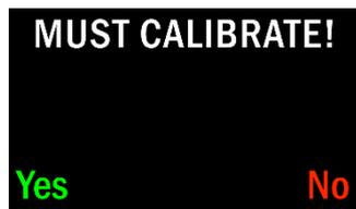
**Calibration !** Sélectionnez « OUI » pour lancer la calibration des cellules O2 et remettre à zéro le senseur CO2 s'il est installé.
