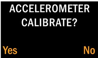
Le système propose alors de calibrer l'accéléromètre. Ce n'est pas nécessaire aussi fréquemment, et n'est impératif qu'à la première utilisation après rechargement du logiciel, ou si les performances du compas s'avèrent trop médiocres.
