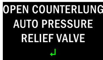
**Consigne** Vérifiez que la purge automatique est sur « plongée ». Dévissez la valve à fond (sens anti-horaire) jusqu'à encliquetage.
