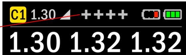
S'il n'y a pas d'indicateur d'état de la chaux, mais un détecteur de CO<sub>2</sub>, une ligne de ++++ est affichée. Si les 2 options sont installées, une ligne de ++++ sera affichée si le bouton Gauche est maintenu appuyé, pour confirmer la présence du détecteur de CO<sub>2</sub>.
