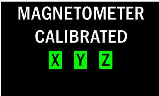
Si au bout des 15 secondes toutes les barres sont passées au vert, la calibration sera réussie, ce qui appelle l'écran suivant « magnétomètre calibré ».
