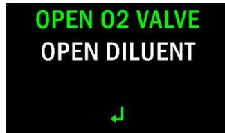
**Consigne** Assurez-vous que le robinet diluant est ouvert. Vérifiez le manomètre O2 pour vérifier la pression du bloc. Actionnez l'inflateur manuel diluant (gauche) en regardant le manomètre. Si l'aiguille ne dévie pas, vous serez sûr que le bloc est suffisamment ouvert et que l'inflateur est correctement alimenté. Appuyer sur l'ADV pour s'assurer qu'il est alimenté.
